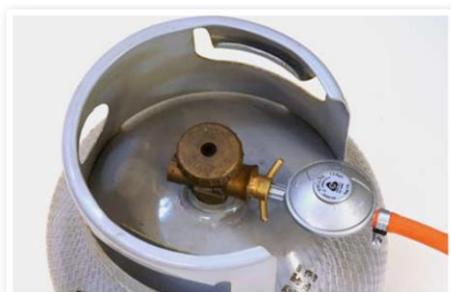
Gasolbehållare med monterad reduceringsventil
